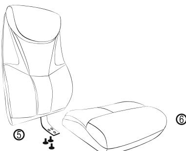
3. Подлокотники ⑦ прикрутите (не затягивая) сначала к спинке ⑤, затем к сиденью ⑥, шестигранным ключом №6, затем затяните все четыре винта. Рекомендуется затягивать все четыре винта до проворачивания.
