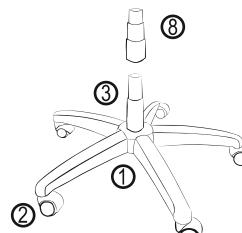
5. Сиденье установите отверстием в механизм ④ на газлифт ③.
