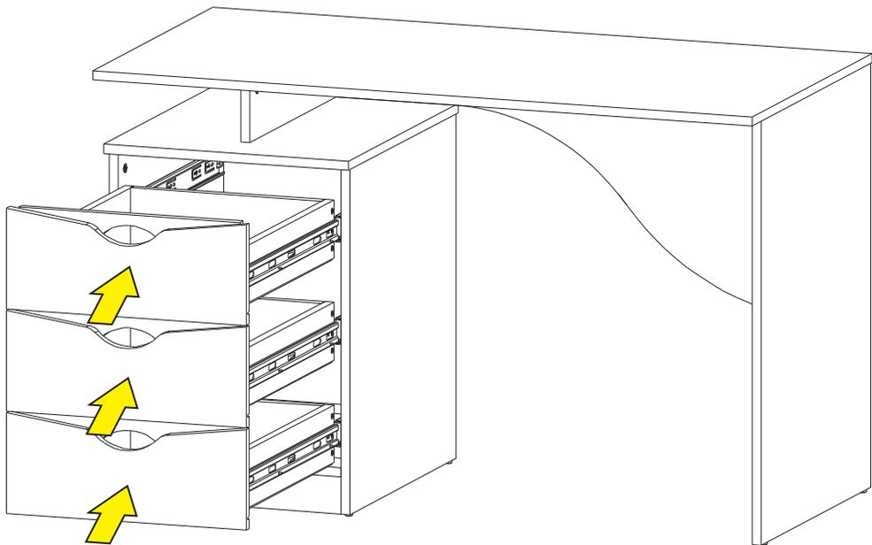
монтаж, демонтаж шариков направляющих
